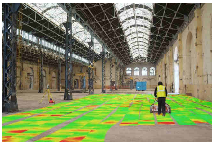
Détection de cavités.
